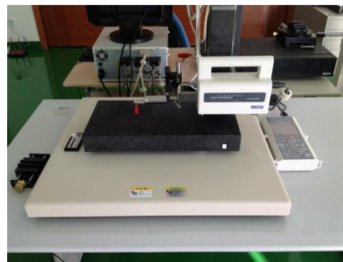
【粗さ測定機】日本製 東京精密製 SURFCOM FLEX-50A
